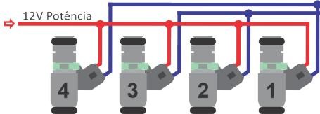
**Exemplo** de ligação da primeira bancada de injetores em um motor 4 cilindros no modo semi-sequencial
