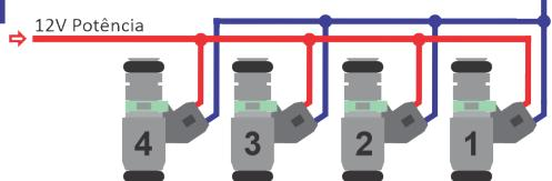
**Exemplo** de ligação da segunda bancada de injetores utilizando a Banca-C.
